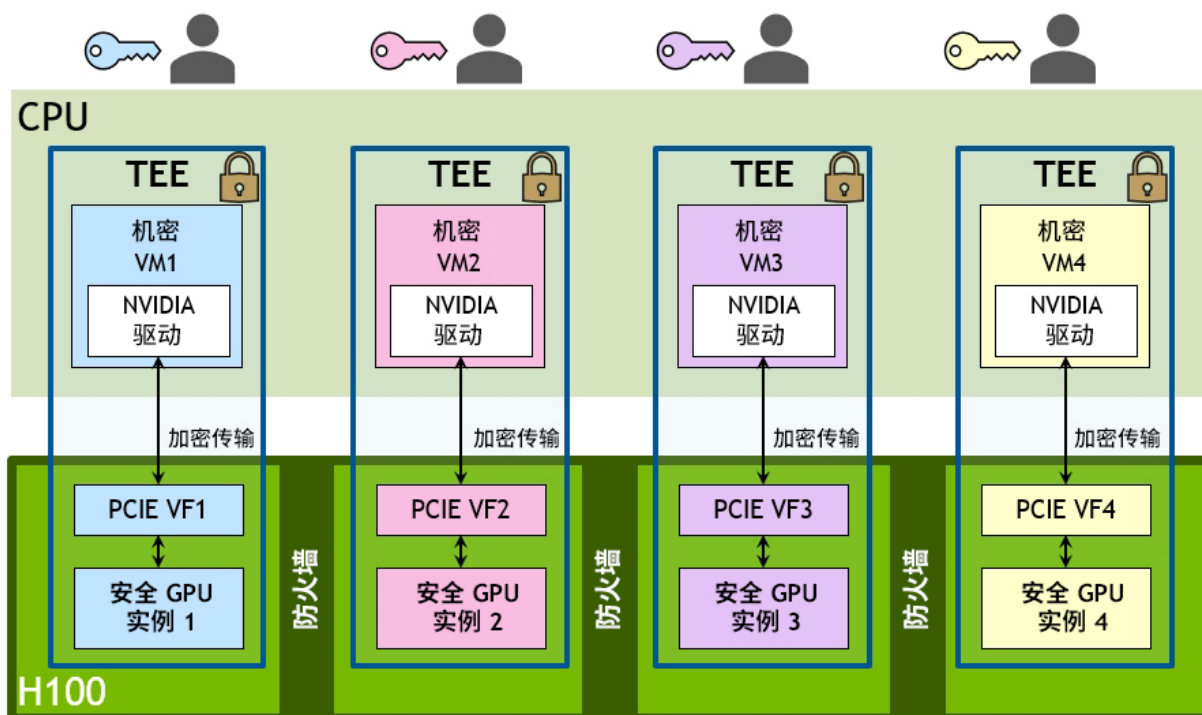
图 23. 多租户单 GPU 配置中的安全 MIG 示例
