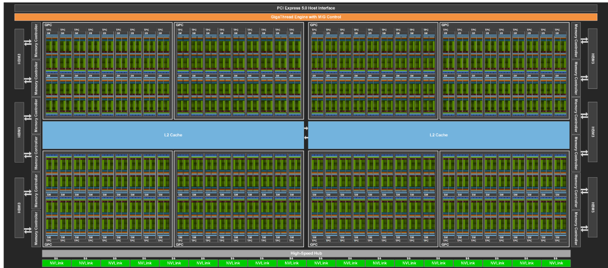
图 6. 配备 144 个 SM 的完整 GH100 GPU 核心
